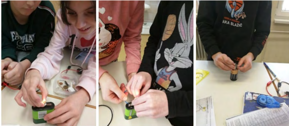
Slika 2: Električni krog – žarnica, ploščata baterija in žarnica, baterija, ena žica ter 1,5 V baterija in ena žica. Vir: lasten
